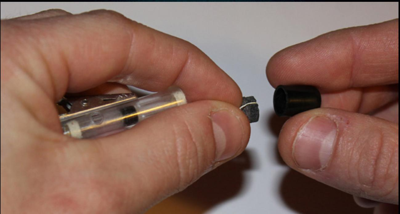
Retirez alors le capuchon de l'autre coté et sortez la bobine du corps en plastique. Si le fil est entortillé dans l'élastique blanc, il faut le casser, retirer autant que possible ce qui reste sur l'élastique, enrouler (si nécessaire) le fil sur la bobine et re-plaquer l'extrémité du fil contre la bobine en le lissant avec un doigt.
