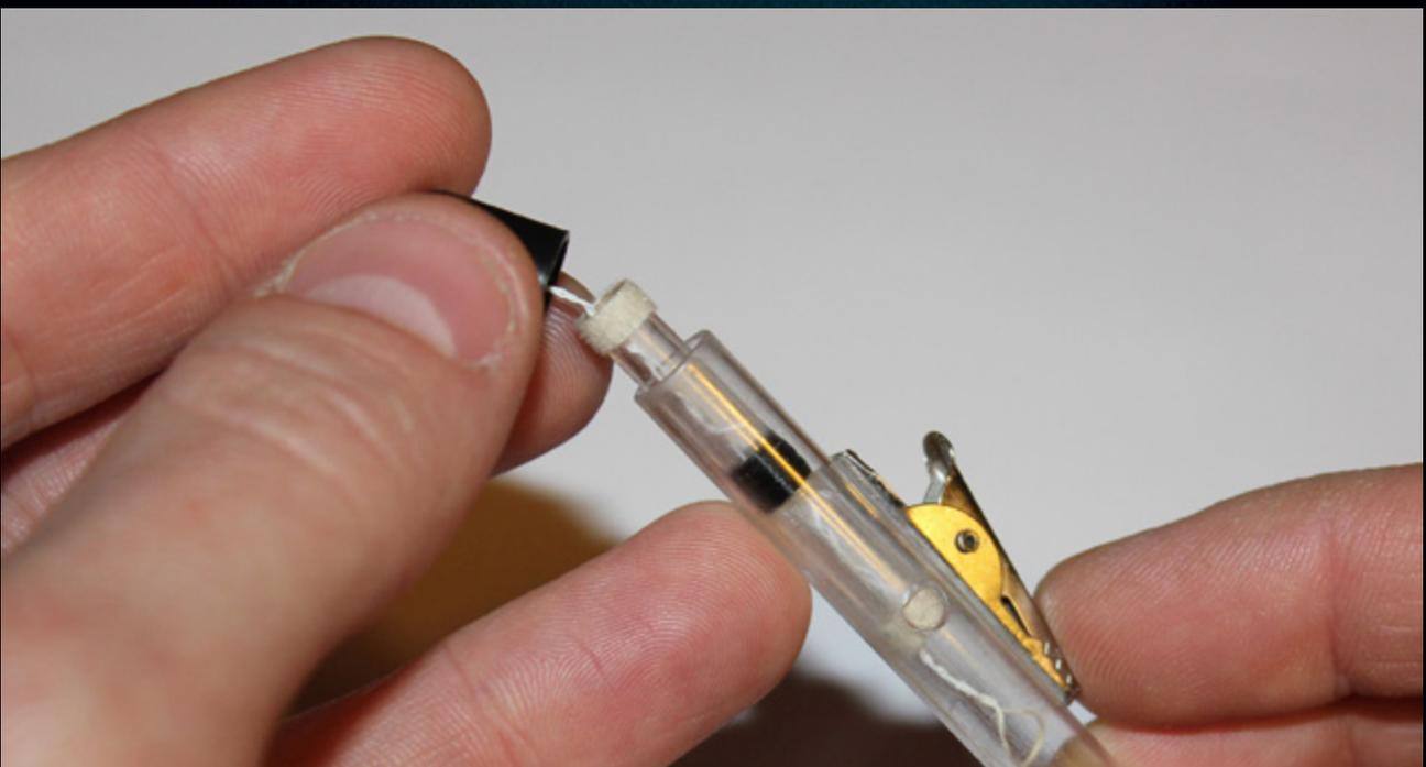
Avec une pince à épiler, récupérez l'élastique et remettez-le sur la pastille en caoutchouc avant de remettre le capuchon sur le tout.
